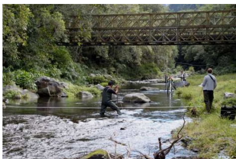
Opération de diagnostic Carhyce (caractérisation hydromorphologique des cours d'eau) – Rivière Langevin
